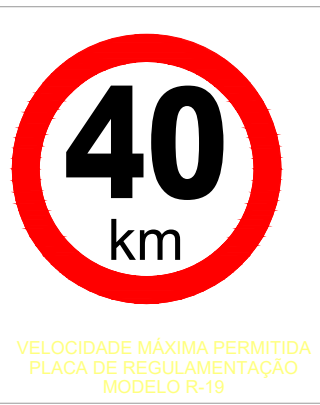
DETALHE PLACA DE TRÂNSITO ESC. 1:10
